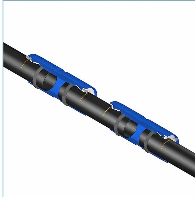
10. Setzen Sie das neue Rohrstück zwischen die beiden Kupplungen.
