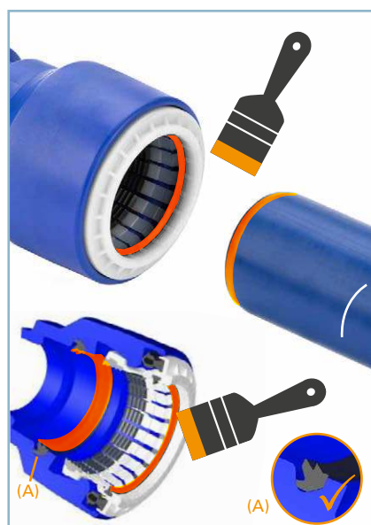
Den korrekten Sitz der Dichtung (A) prüfen. Gleitmittel auf markierte Stellen auftragen. Check the correct seating of the seal (A). Apply lubricant to highlighted locations.
