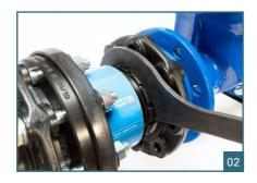
Haken Sie den Hakenschlüssel wie gezeigt in eine der Nuten an der Losflansch-Seite des QUICK-TWIST ein.
