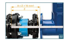
Stellen sie sicher, dass der maximale Verstellweg des QUICK-TWIST (+ 15 mm im Standard) ausreicht, um den Montagespalt zu überbrücken und die Flanschverbindung zur Armatur herstellen zu können. Berücksichtigen Sie dabei auch die Dicke der Profildichtung.
