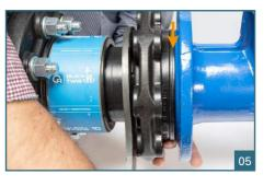
Bringen Sie die Profildichtung in die richtige Position am Armaturenflansch und stellen mit einer Drehbewegung den HP-Flansch des QUICK-TWIST soweit zu, dass die Profildichtung soeben gehalten wird.
