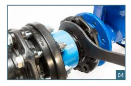
Haken Sie den Hakenschlüssel wie gezeigt in eine der Nuten an der Losflansch-Seite des QUICK-TWIST ein.
