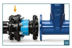
Montieren Sie zuerst die Festflansch-Seite (Sonderflansch VP) des QUICK-TWIST am Gegenflansch. Eine Profildichtung ist hierfür nicht erforderlich, da eine O-Ring-Dichtung vorhanden ist.
